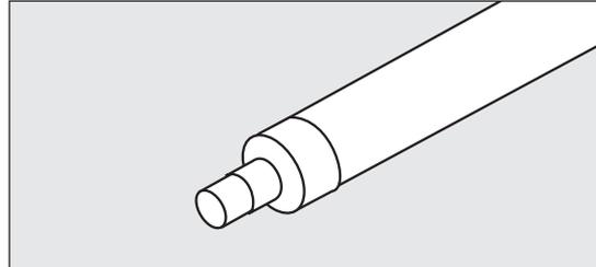
7. Die Montage ist fertig, wenn die Dichtungsmasse an das Mediumrohr hervortritt und die Endkappe glatt ist.
